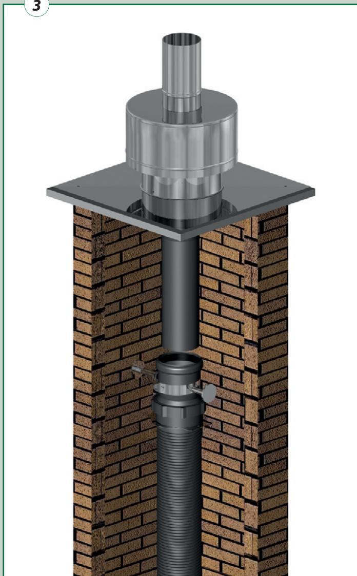
Le dernier élément de tube avant la fermeture de la cheminée doit être conçu comme un élément rigide, à fixé dans l'entretoise de la fermeture de la cheminée et le tube terminal de la fermeture cheminée et à insérer dans le manchon du tube en plastique rigide (1).
