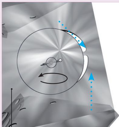
Disque excentrique permettant un réglage en continu du flux d'air entrant
